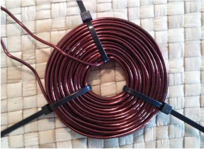
Abb. 20: Spule aus Kupferlackdraht und Kabelbinder
