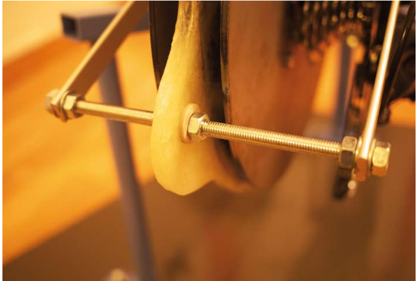
Abb. 18: hinterer Befestigungspunkt mit Gewindestange und Muttern
