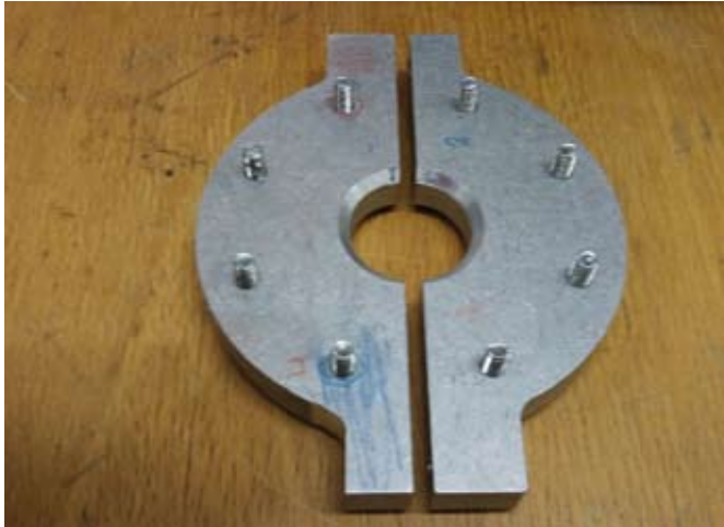
Abb. 15: Vorderseite des Flansches mit Fase und acht M5-Schrauben
